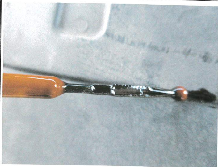
Fot.14. Widok wskaźnika poziomu oleju silnika
